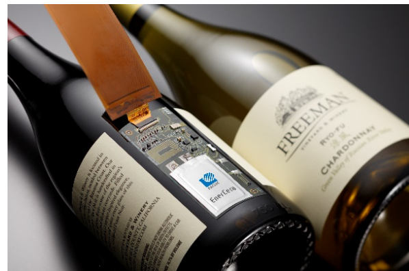
センサータグをワインボトルに装着した例
