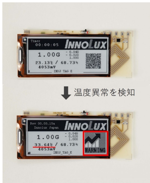
温度異常を検知した場合の電子ペーパーディスプレイへの表示例
